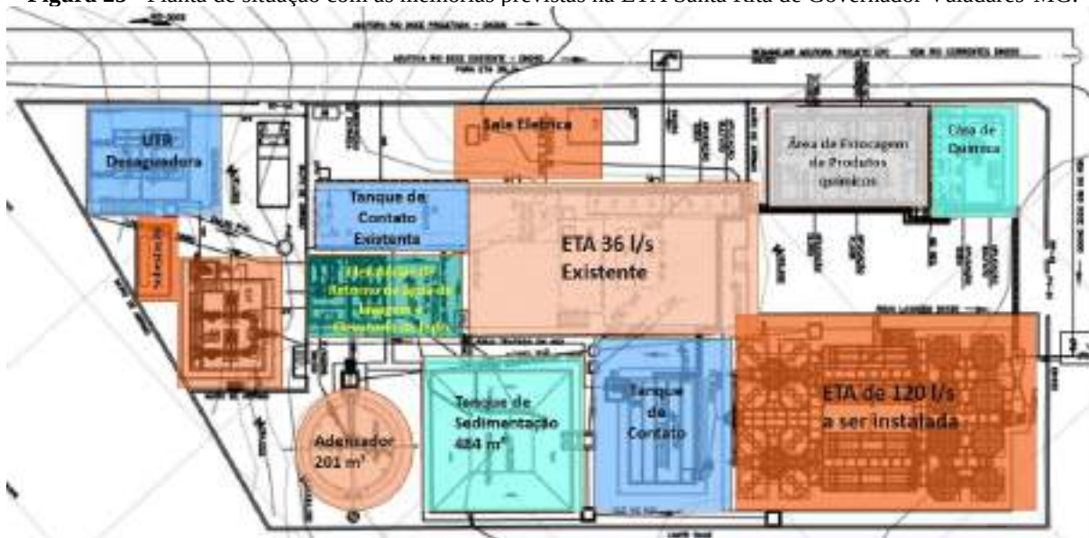
Figura 25 - Planta de situação com as melhorias previstas na ETA Santa Rita de Governador Valadares-MG.
